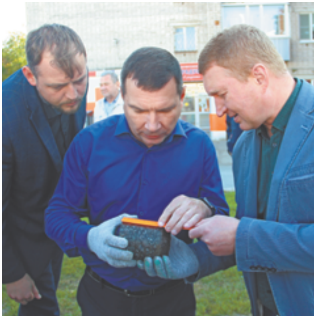
Толщину кернов измеряют на месте. Затем образцы отправляются в лабораторию
