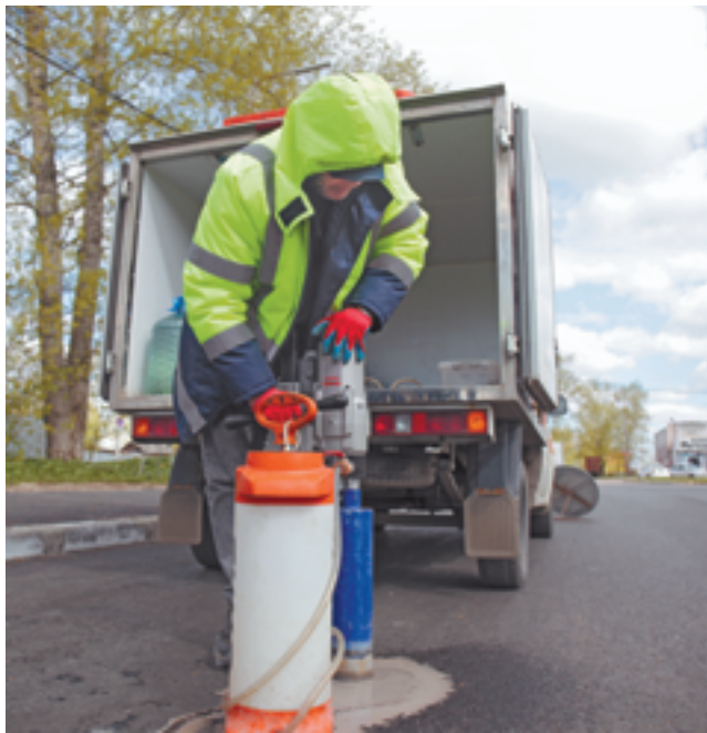
Пробы асфальта отправляются в лабораторию, где асфальт проверяют на водонасыщение и плотность
