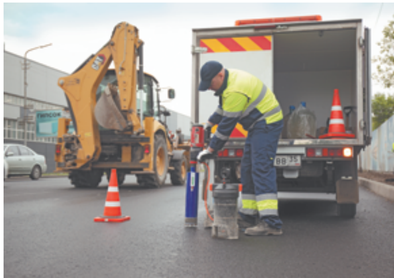
❷ После укладки асфальта обязательно берут образцы для контрольного исследования в лаборатории
