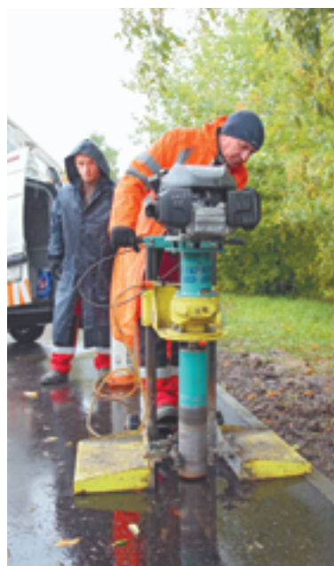
С тротуаров после ремонта берут пробы асфальта
